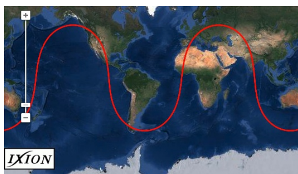
FIGURE 1 – Trace de l'orbite sur une journée d'un satellite GPS (PRN 32, le 25 février 2015). Le phasage avec la rotation de la Terre induit une trace répétitive : les mêmes points de la Terre sont survolés tous les jours (mais pas aux mêmes heures). © Google maps.
