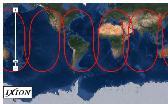
FIGURE 2 – Trace de l'orbite sur trois jours d'un satellite Galileo (Galileo-FM4, à partir du 25 février 2015). La trace de l'orbite formerait une boucle fermée si elle avait été représentée sur 10 jours. © Google maps.
