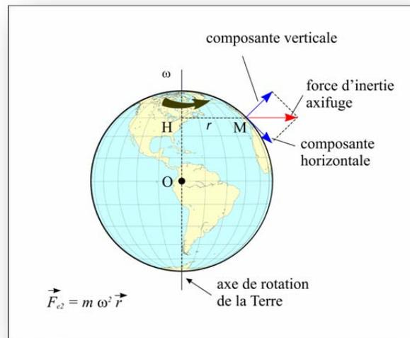
Figure 3 : la force d'inertie axifuge
