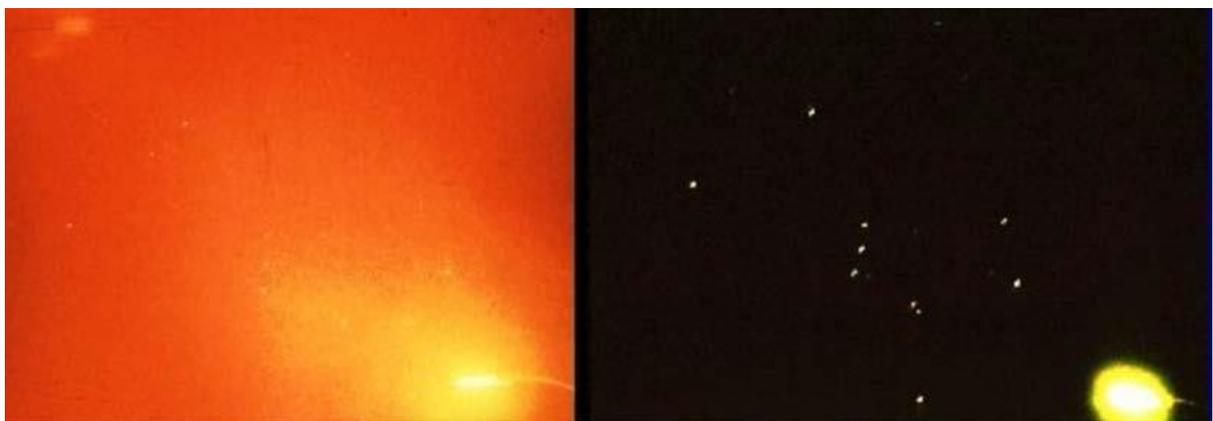
*Avant et après utilisation d'un filtre LPR sur une lampe au sodium*
