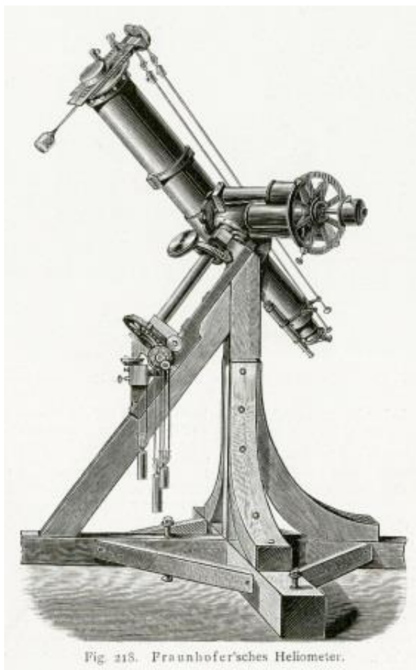
Héliomètre de Bessel de 6 pouces (16 cm) construit par Fraunhofer en 1834 (Atlas der Himmelskunde, Schweiger-Lerchenfeld, 1898, Bibliothèque de l'Observatoire de Paris).
