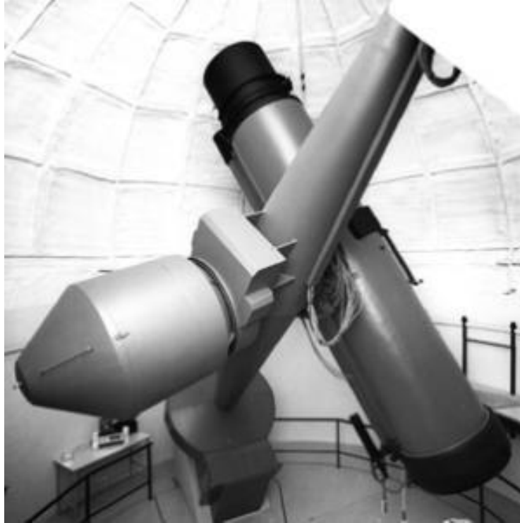
Le télescope franco-belge de Schmidt de l'observatoire de Haute Provence. On remarque que la lentille correctrice diminue l'ouverture du télescope ce qui donne cet aspect particulier au télescope de Schmidt
