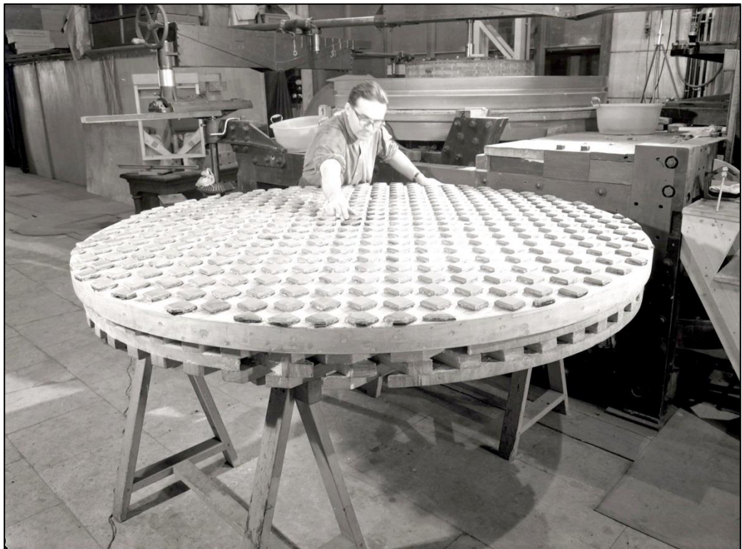
Outil sur pieds destiné à polir le miroir de 193 cm qui équipera l'Observatoire de Haute-Provence en 1958. Jean Texereau (1919-2014) contrôlant les plaquettes de résine sur l'outil de taille (Bibliothèque de l'Observatoire de Paris).
