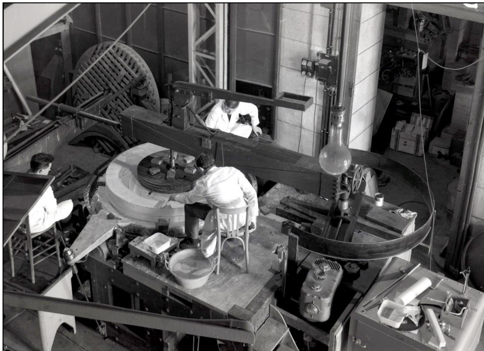
Polissage d'un miroir de 152 cm destiné à l'Observatoire de Haute Provence en 1967 (Bibliothèque de l'Observatoire de Paris)
