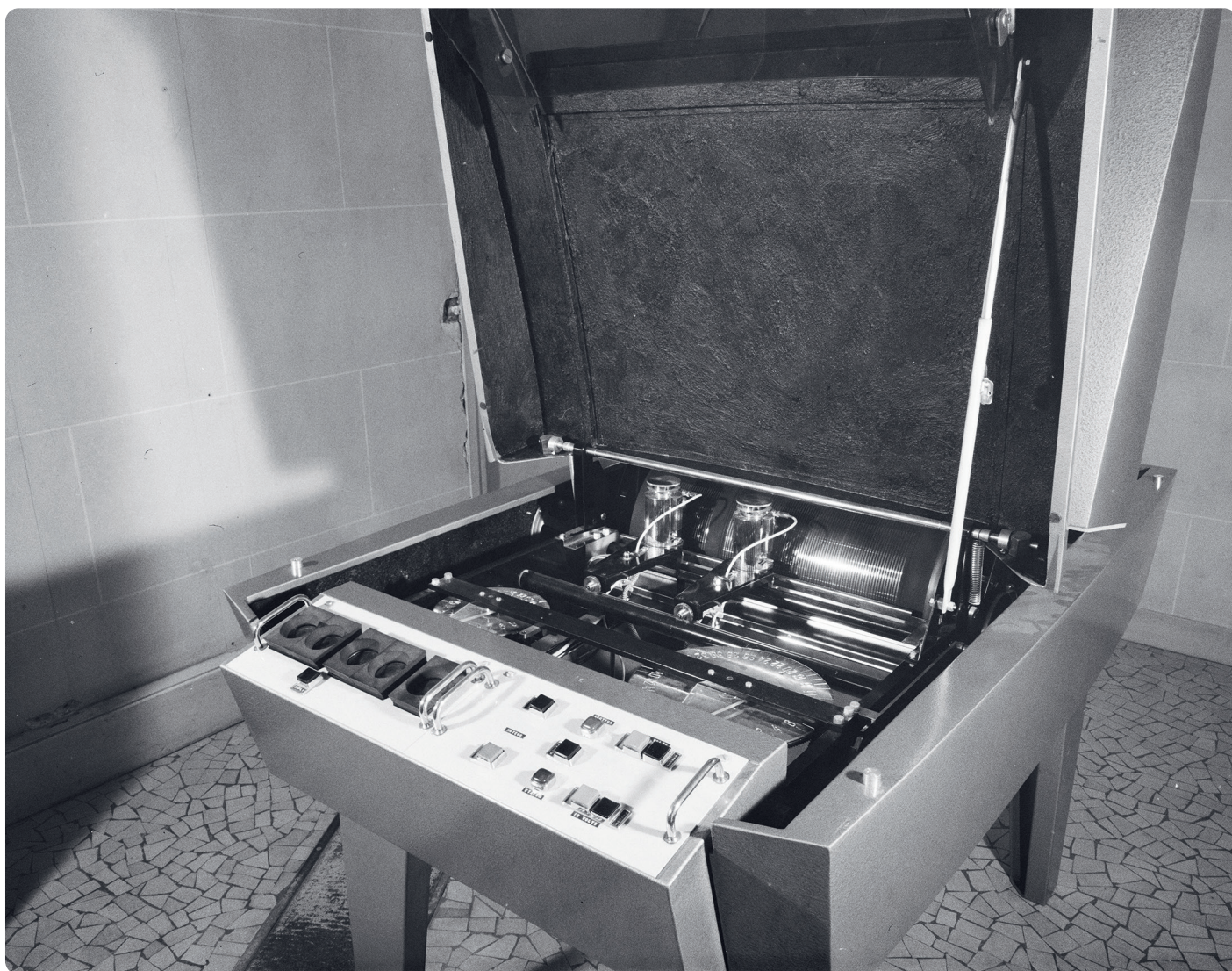
Une machine parlante type 1965 (dite « à capot de 2CV Citroën ») (taille en centimètres : H 100, L 140, l 85).
