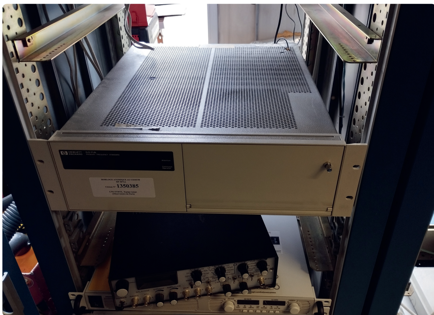
Une horloge atomique à césium HP5071A représentative des horloges associées aux machines parlantes type 1991.
